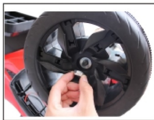
12. Fixați roata față cu șaibă și piuliță.
